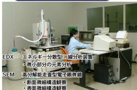
EDX エネルギー分散型 X 線分析装置
