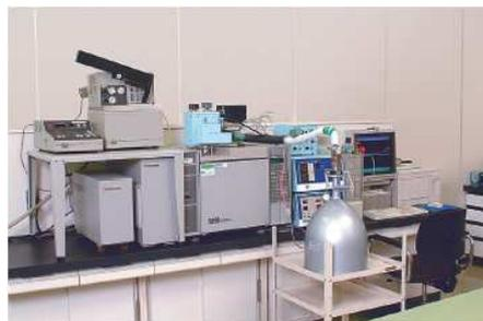
GC-MS ガスクロマトグラフィー・質量分析装置
