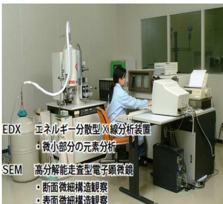
EDX エネルギー分散型X線分析装置
